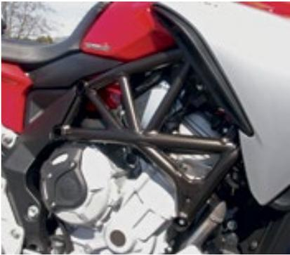
Als Antrieb dient ein knackiger Dreizylinder, und für die Stabilität des Chassis sorgt ein Gitterrohrrahmen.
